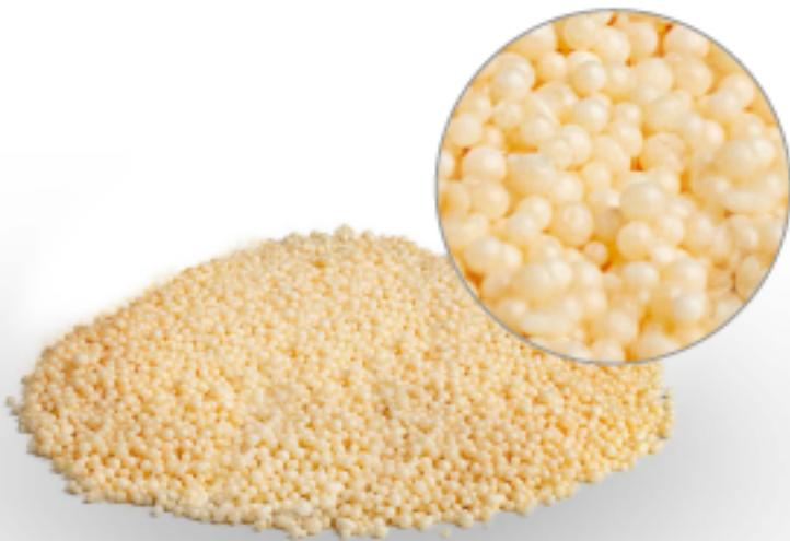
ГРАНУЛИТ-ПН™ – торговая марка промышленного взрывчатого вещества (bulk) типа ANFO, выпускаемого компанией АО «НИТРО СИБИРЬ».
