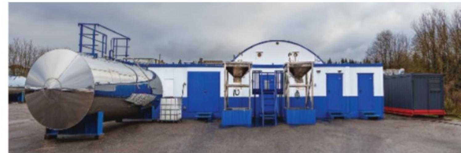
Тенденции современных горных работ, требующие высокой скорости мобилизации, надежности и автоматизации, привели НИТРО СИБИРЬ к разработке нового поколения модульных заводов контейнерного типа «МЭКТ», позволяющих организовать производство ЭВВ в кратчайшие сроки. Производственная мощность данной линейки заводов варьируется от 10 до 50 тыс. т эмульсионного взрывчатого вещества в год.
